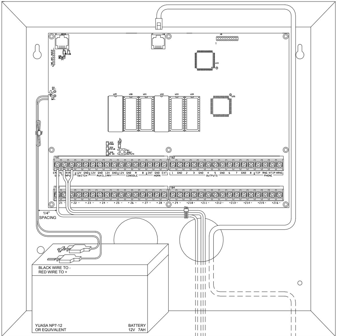
THE BATTERY IS NON-POWER LIMITED. THE BATTERY LEADS MUST BE SEPERATED FROM ALL OTHER POWER LIMITED/CLASS II WIRING IN THE ENCLOSURE BY AT LEAST 1/4"
