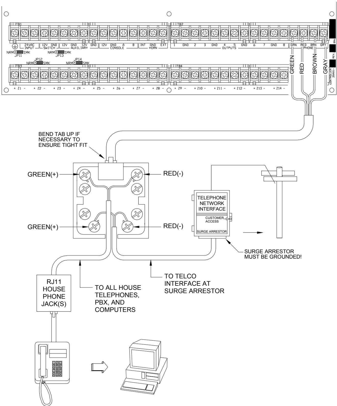
**FIGURE 5 - RJ31X JACK CONNECTIONS**
