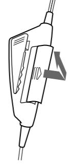
2 Insérez une pile R03 (format AAA) en alignant les polarités + et - de la pile sur celles du boîtier de la pile.
