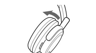
**2** Abra la tapa del contenedor de las pilas del auricular para insertar una pila de tamaño AAA.
