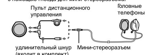
При подключении непосредственно к проигрывателю мини-дисков WALKMAN®, проигрывателю компакт-дисков WALKMAN® или другому устройству WALKMAN® с помощью гнезда для мини-стереоразъема.
