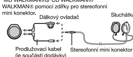
Při pripojování přímo k přístroji MD WALKMAN®, CD WALKMAN® nebo WALKMAN® pomocí zdírky pro stereofonní mini konektor.
