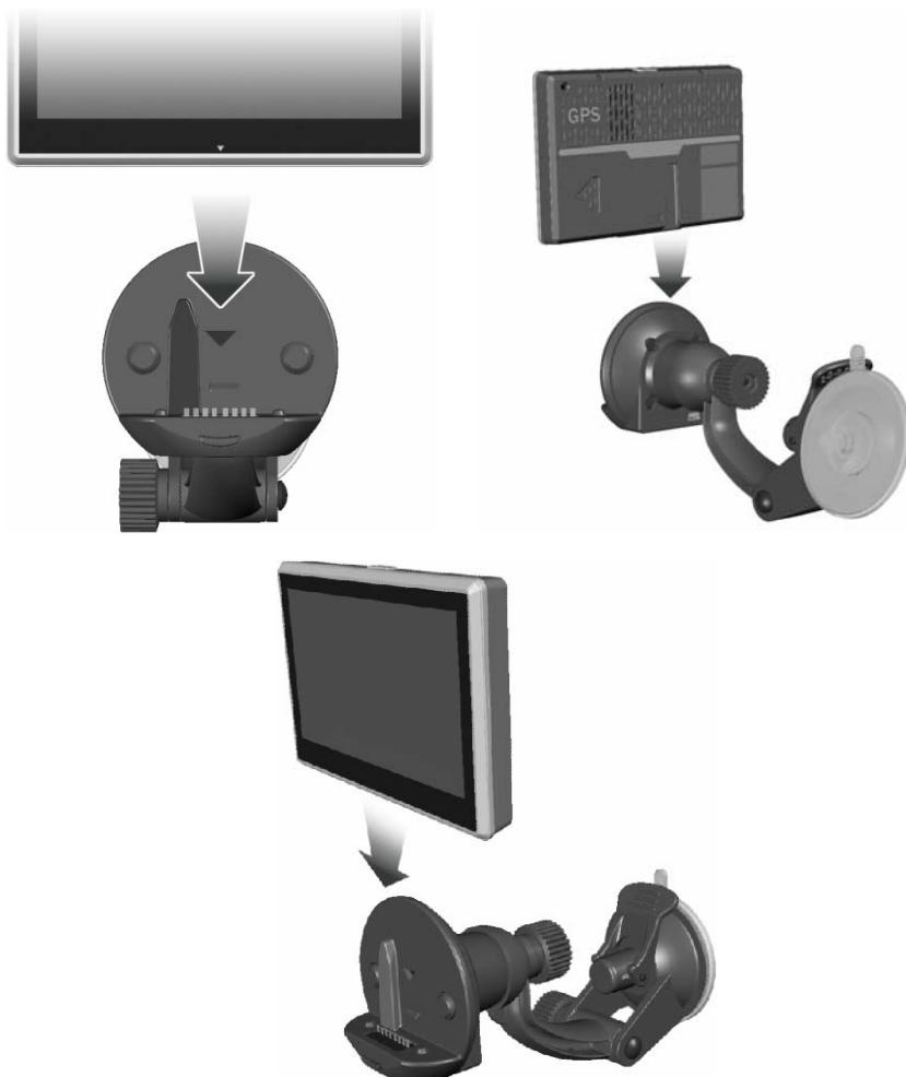
**Nota:** Tenha em atenção a direcção indicada pelas setas, o conjunto deve ficar bem preso após a introdução do dispositivo no suporte. Se não seguir estas instruções, o dispositivo pode não ficar correctamente colocado no suporte pelo que terá de repetir a operação.
