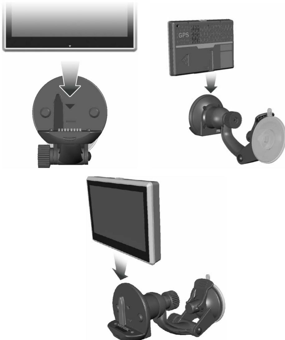
**Hinweis:** Achten Sie beim Anbringen auf die Pfeilrichtung, so dass das Gerät sicher befestigt wird. Wird diese Richtung nicht eingehalten, wird das Gerät zu locker befestigt und die Komponenten müssen nochmals montiert werden.
