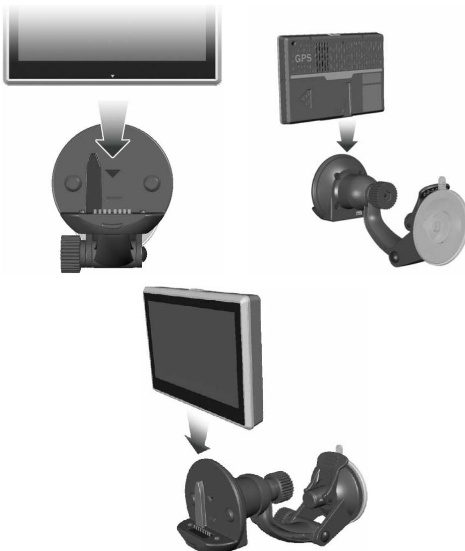
**Nota:** Si prega di notare la direzione delle frecce. Quando il supporto è fissato, l'installazione deve essere fissa. Se non si seguono queste direzioni, l'assemblaggio sarà allentato ed i componenti devono essere assemblati di nuovo.
