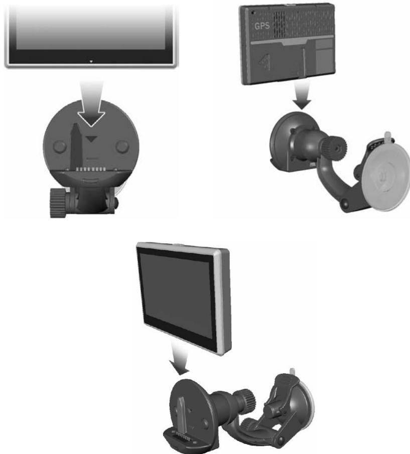
**Nota:** tenga en cuenta las direcciones de las flechas. El módulo debe estar firmemente sujetado cuando quede ajustado. Si no sigue estas indicaciones, el ajuste puede quedar suelto y puede ser necesario volver a montar los componentes.
