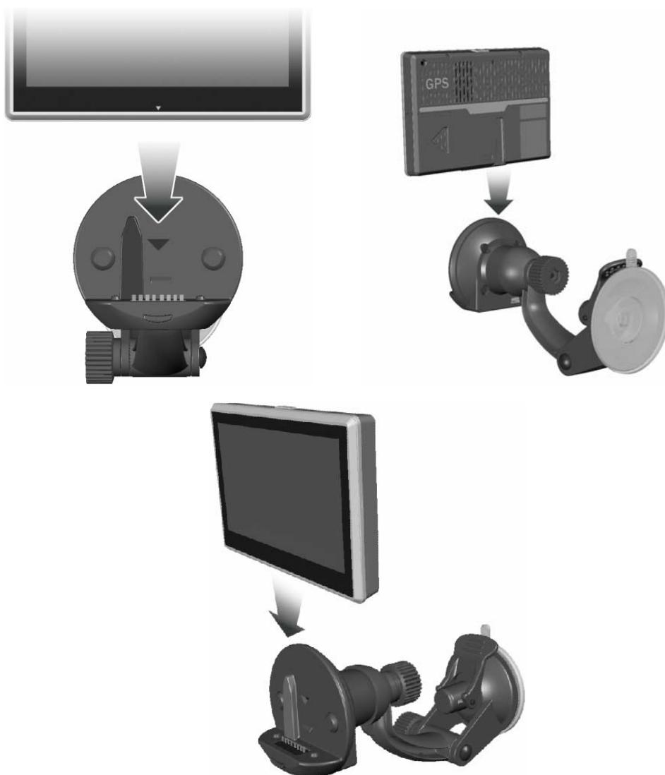
**Note :** Veuillez bien noter le sens des flèches. Lorsque installé, l'ensemble doit bien tenir. Si les sens ne sont pas respectés, il y aura du jeu et les composants devront être assemblés à nouveau.
