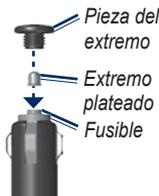
3. Asegúrese de que el extremo plateado se coloca en la pieza con el extremo negro. Atornille la pieza con el extremo negro.
