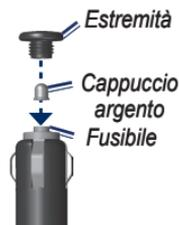
2. Rimuovere il fusibile (cilindro di vetro color argento) e sostituirlo con un fusibile rapido 3A.
