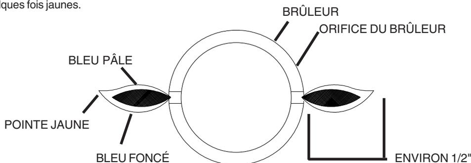
Si le brûleur ne reçoit pas assez d'air, les flammes seront jaunes et lâches, et produiront possiblement des dépôts de carbone. Si le brûleur reçoit trop d'air, les flammes se détacheront du brûleur de façon irrégulière et causeront possiblement des problèmes d'allumage.
