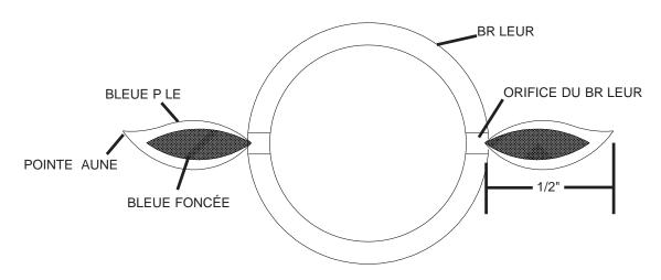
Si le brûleur ne reçoit pas assez d'air, les flammes seront jaunes pâles et produiront possiblement de la suie. Si le brûleur reçoit trop d'air, les flammes scintilleront de façon erratique et causeront possiblement des problèmes d'allumage.
