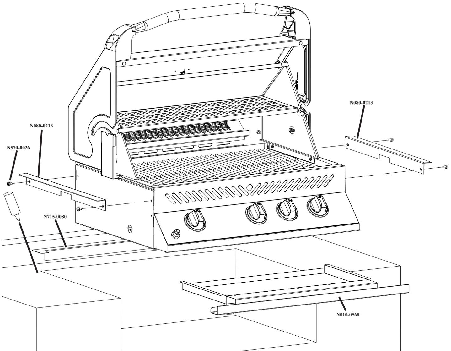
Ce gril est conçu pour des cabinets INCOMBUSTIBLES OU EN MAÇONNERIE seulement et doit être installé et entretenu par un installateur qualifié selon les codes locaux.
