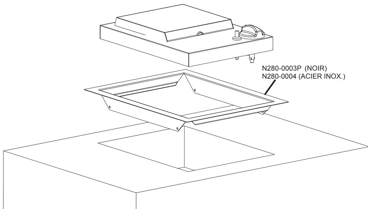
1. Placez le cadre du brûleur latéral dans l'ouverture. Le cadre doit être fixé à l'ouverture pour qu'il ne puisse pas bouger (pièces de fixation non comprises).
