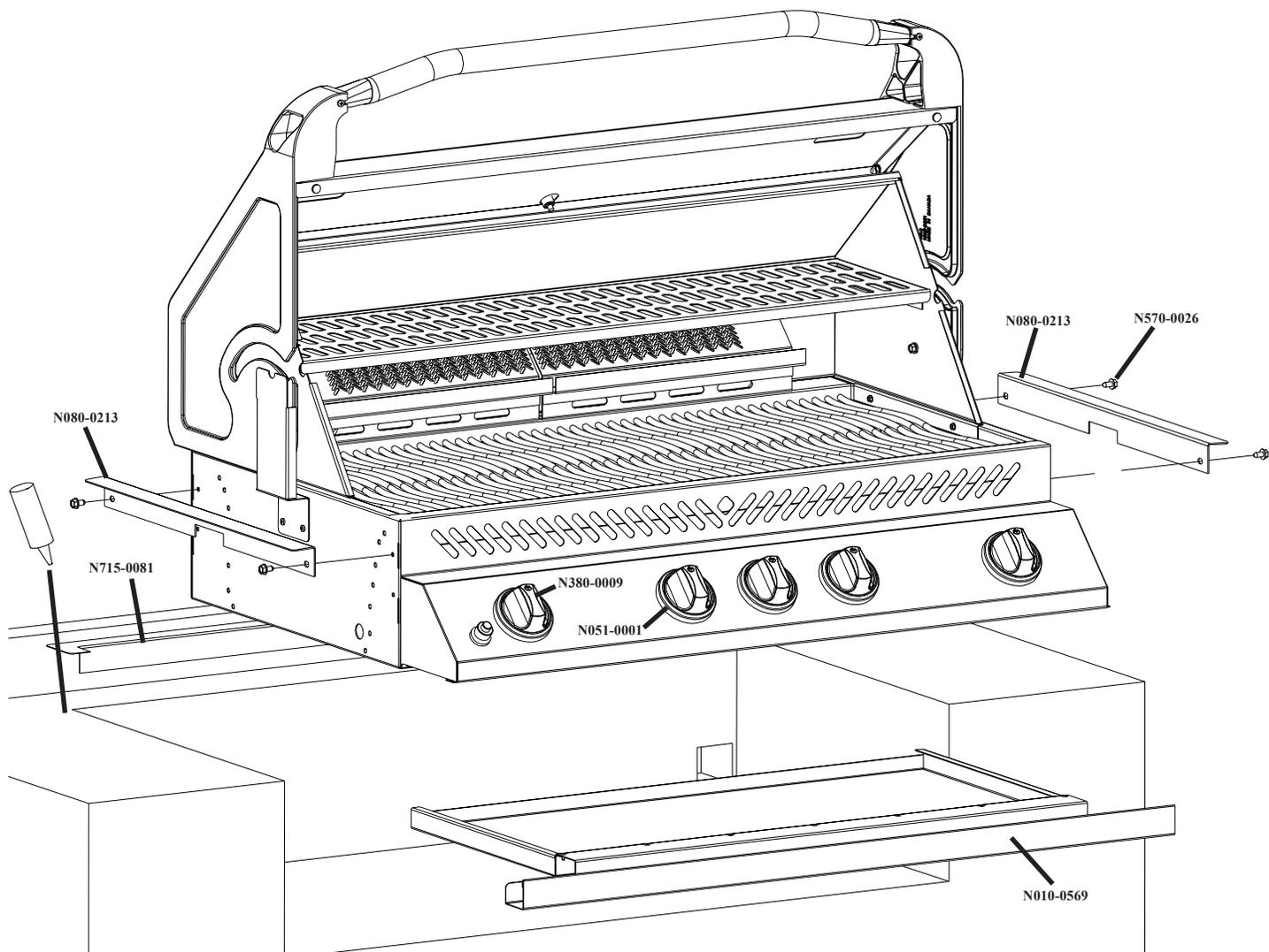
Ce gril est conçu pour des cabinets INCOMBUSTIBLES OU EN MAÇONNERIE seulement et doit être installé et entretenu par un installateur qualifié selon les codes locaux.
