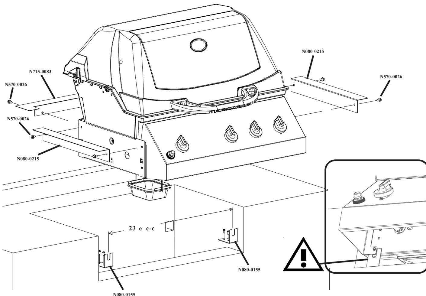
Ce gril est conçu pour des cabinets INCOMBUSTIBLES OU EN MAÇONNERIE seulement et doit être installé et entretenu par un installateur qualifié selon les codes locaux. Vous devez prévoir un accès dans le cabinet pour permettre l'enlèvement et le nettoyage du tiroir d'égouttement.
