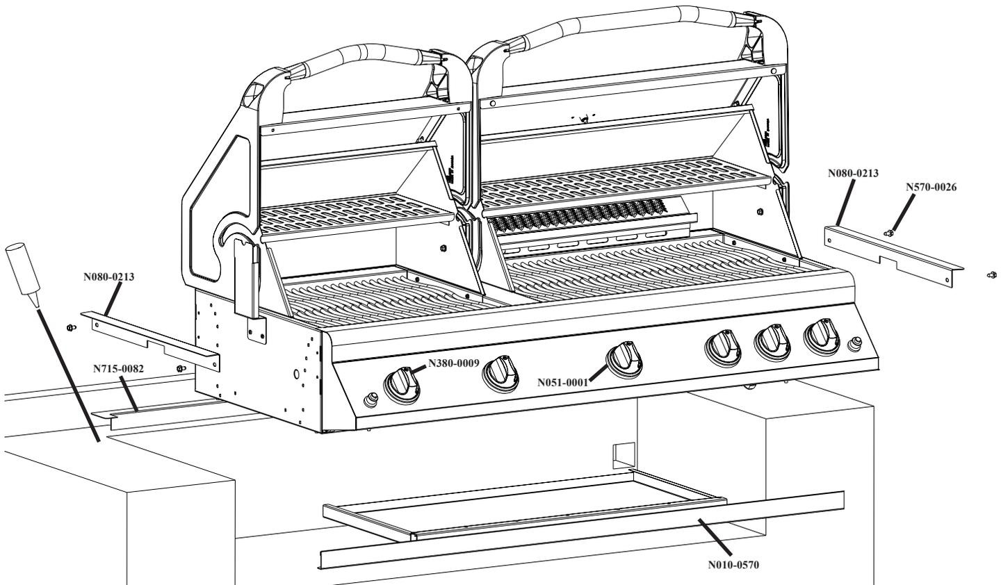
Ce gril est conçu pour des cabinets INCOMBUSTIBLES OU EN MAÇONNERIE seulement et doit être installé et entretenu par un installateur qualifié selon les codes locaux.
