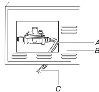
A. Conduit de raccordement flexible neuf, pour l'utilisation à l'extérieur (homologation CSA International)
