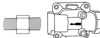
9. Utiliser une clé à tuyauterie pour installer le détendeur convertible. Une fois fixé, le chapeau de laiton doit être orienté vers le haut.
