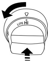
3. Vous verrez l'allumeur s'allumer ou entendrez le "déclat" de l'allumage (selon le modèle utilisé). Lorsque le brûleur est allumé, relâcher le bouton; tourner le bouton de commande au réglage désiré.
