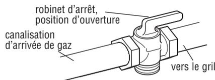
La canalisation d'arrivée de gaz doit être dotée d'un robinet d'arrêt homologué. Ce robinet devrait être au voisinage du gril, à un endroit où on peut y accéder facilement pour les manœuvres d'ouverture et de fermeture. Ne pas entraver l'accès au robinet d'arrêt. Le robinet permet d'ouvrir ou de fermer l'alimentation en gaz de l'appareil.
