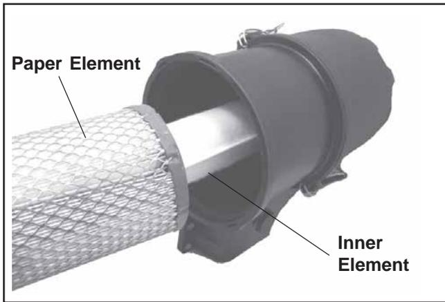
**Figure 21. Removing Elements.**
