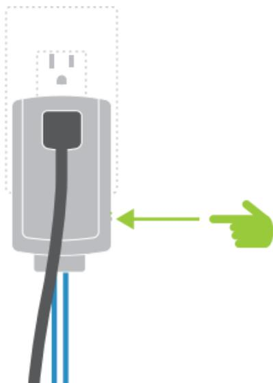
Acheminez et fixez solidement les fils du capteur le long du rail, jusqu'au moteur. Branchez le module I/O Linc et le moteur de l'ouvre-porte de garage dans la prise de courant.
