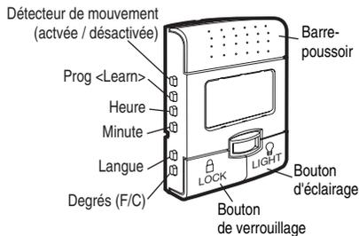
Cette console de commande contient un détecteur de mouvement, le témoin duquel s'allumera dès la détection de l'entrée d'une personne dans la garage.
