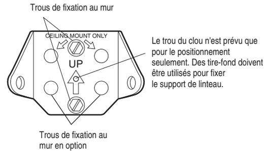
Le trou du clou n'est prévu que pour le positionnement seulement. Des tire-fond doivent être utilisés pour fixer le support de linteau.
