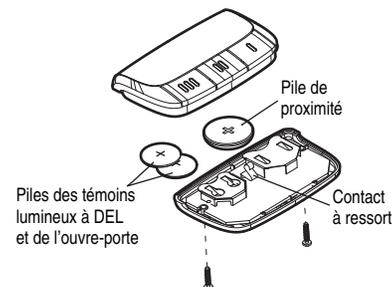
Ne remplacer les piles qu'avec des piles de type capsule 3V2016 ou 3V2450.
