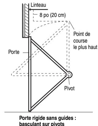
Porte rigide sans guides : basculant sur pivots
