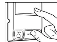
4. Relâcher les boutons lorsque l'éclairage du moteur clignote. Il a appris le code. Si les ampoules ne sont pas posées, deux clics se feront entendre.
