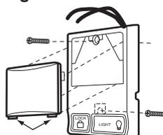
Pour remettre le couvercle en place, insérer les languettes inférieures en premier
