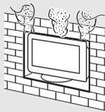
Tel qu'illustré ci-dessous, laissez de l'espace autour du téléviseur. Sinon, il est possible que la circulation d'air soit inadéquate, ce qui peut entraîner une surchauffe susceptible de déclencher un incendie ou d'endommager le téléviseur.
