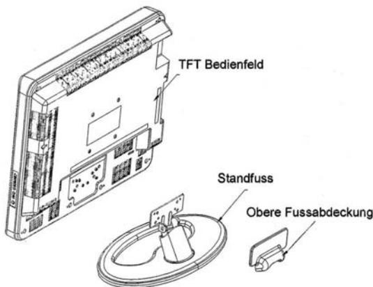
2- Setzen Sie die 4 Aufhänger in die runden Schraubenlöcher an der Rückseite des TFT ein und fixieren Sie sie mit 4 (M4 x 10) Schrauben am TFT-Gerät.
