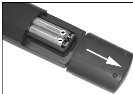
**HINWEIS:** Nehmen Sie die Batterie aus der Fernbedienung heraus, wenn das Gerät längere Zeit nicht benutzt wird. Die Fernbedienung könnte andernfalls durch die auslaufende Batterie beschädigt werden.
