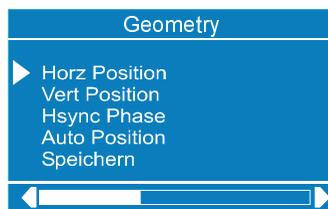
Stellen Sie mit den Tasten "◀", "▶" die erforderliche Horizontal-, Vertikallage oder Hsync-Phase ein.
