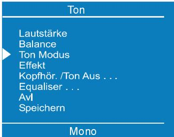
Bei Zweikanalton-Übertragungen (Dual) können Sie mit dem Modus zwischen Originalton und synchronisierter Sprache wählen.
