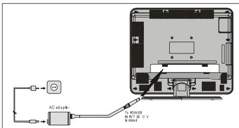
**WICHTIGER HINWEIS:** Das Fernsehgerät ist für 12 V Gleichstrom ausgelegt. Daher wird ein Netzgerät verwendet, das 12 V DC Spannung liefert. Schließen Sie das Netzgerät an eine Spannungsquelle mit 230V AC, 50 Hz an.
