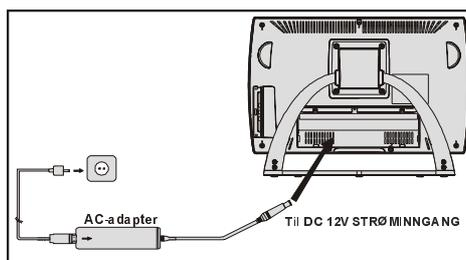
**VIKTIG:** tv-en er beregnet for å drives på 12V DC. For dette brukes en adapter som gir 12V DC. Koble denne adapteren til et system som gir 100–240V AC, 50 Hz.
