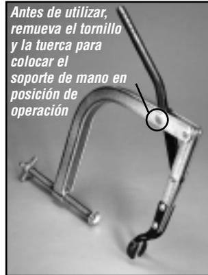
**Nota:** Antes de usar el compresor, remueva el tornillo y la tuerca, (como lo muestra la ilustración). Resbale el soporte y coloque el ensamblaje alineado, luego coloque el tornillo y asegúrelo con la tuerca al armazón principal, y a través de el soporte y la articulación.
