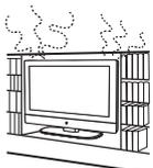
Laissez de la place autour du poste TV de la manière indiquée ci-dessus. Autrement, la circulation de l'air peut s'avérer insuffisante et provoquer la surchauffe de l'appareil, ce qui peut entraîner un incendie ou endommager le poste TV.
