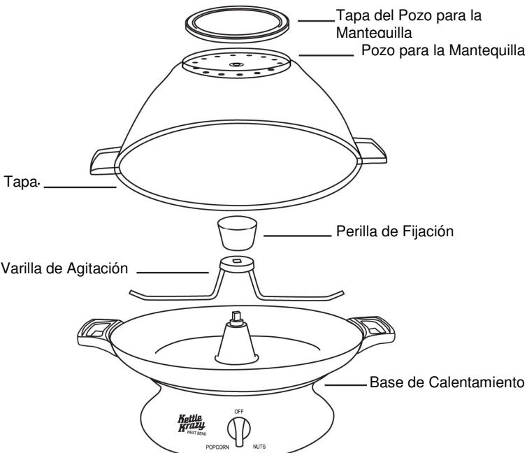
Siga las instrucciones en la sección "Limpieza de su Máquina Kettle Krazy™". **Nota:** Revise periódicamente las asas para asegurarse de que estén completamente apretadas; deberán estar bien fijas y no bambolear. **NO SOBREAPRIETE, PUESTO QUE PUEDE DAÑAR LA ROSCA DE LOS TORNILLOS O ROMPER EL ASA.**
