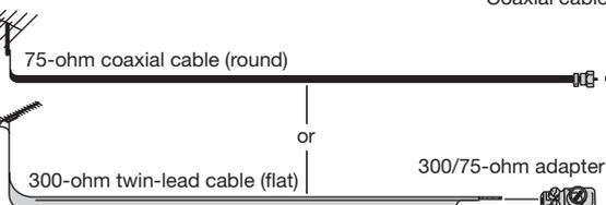
④ **Separate VHF/UHF antenna**
