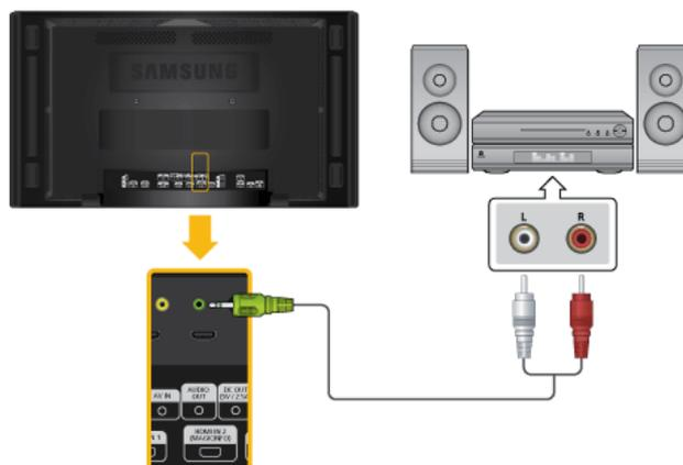
1. Au moyen d'un jeu de câbles audio, reliez les prises AUX L, R du SYSTÈME AUDIO et [AUDIO OUT] de l'écran LCD.
