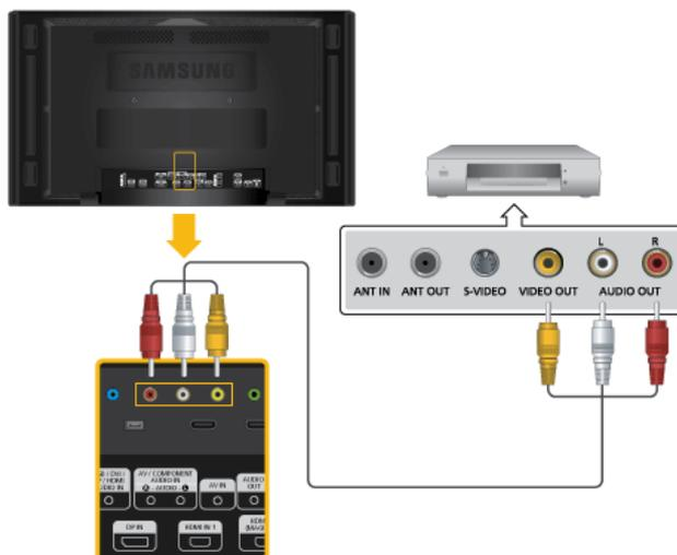
1. Connectez un câble audio à *[AV/COMPONENT AUDIO IN [L-AUDIO-R]]* sur le dispositif et le port audio à un dispositif externe, tel qu'un magnéto-scope ou un lecteur DVD.
