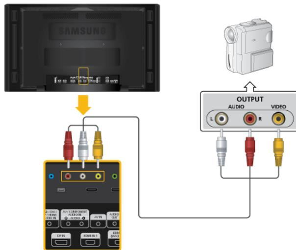
1. Localisez les jacks de sortie AV sur le caméscope. Généralement, ils se situent sur le côté ou au dos du caméscope. Connectez un câble vidéo entre la prise VIDEO OUTPUT du caméscope et la prise *[AV IN]* de l'écran LCD.
