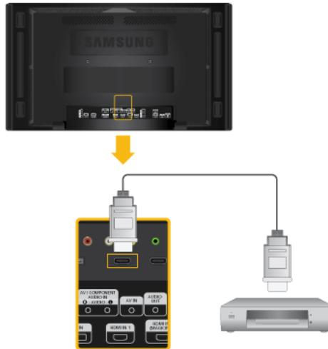
1. Connectez un câble HDMI à *[HDMI IN 2 (MAGICINFO)]* (uniquement avec un modèle 460UT-2, 460UT-B) ou *[HDMI IN 1]* sur le dispositif et le port de sortie HDMI du périphérique numérique.
