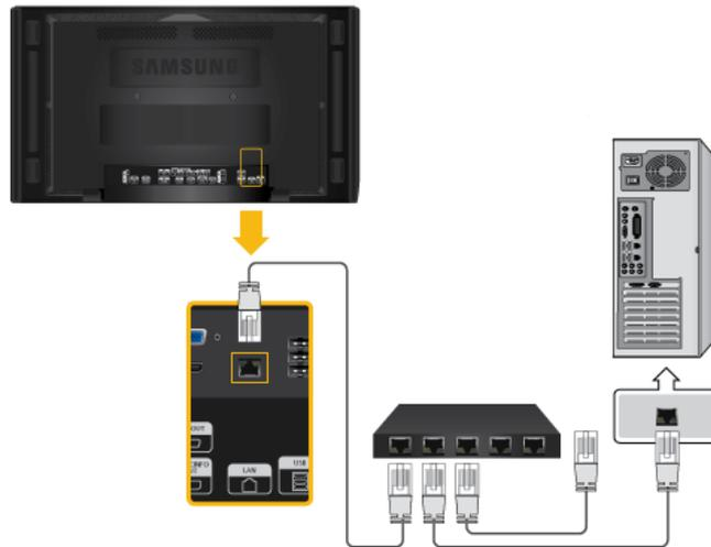
1. Raccordez le câble LAN au port [LAN] du moniteur et au port [LAN] du PC.
