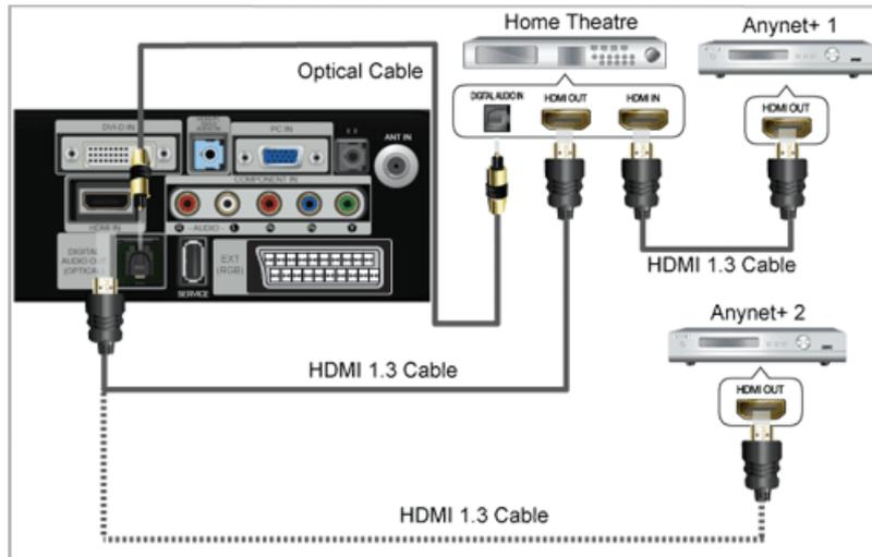
1. Connect the **[HDMI IN]** jack on the TV and the HDMI OUT jack of the corresponding <Anynet+> device using an **HDMI** cable.
