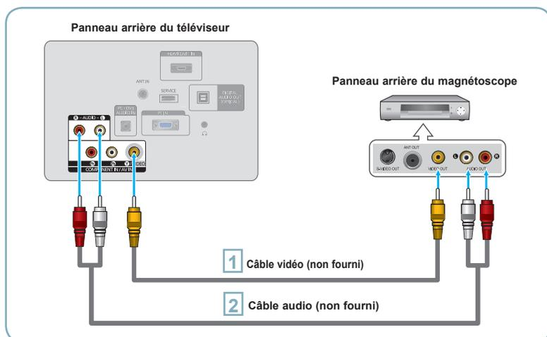
**1** Branchez un câble vidéo entre la prise AV IN [VIDEO] du téléviseur et la prise VIDEO OUT du magnétoscope.
