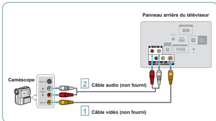
**1** Branchez un câble vidéo entre la prise COMPONENT IN / AV IN [VIDEO] du téléviseur et la prise VIDEO OUT du caméscope.
