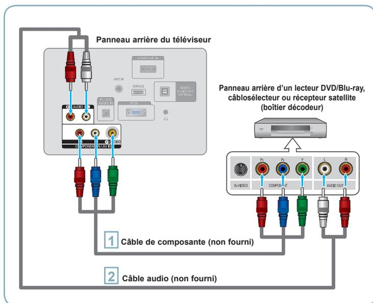
**1** Branchez un câble de composant entre les prises COMPONENT IN [Y, P<sub>B</sub>, P<sub>R</sub>] du téléviseur et les prises COMPONENT [Y, P<sub>B</sub>, P<sub>R</sub>] du lecteur DVD / Blu-ray / câblosélecteur ou récepteur satellite (boîtier décodeur).
