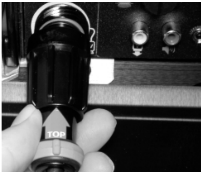
Figura 9 – Conector macho en posición de acoplado
