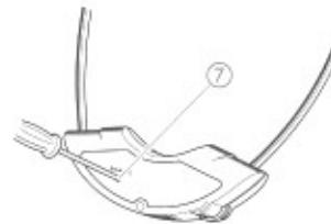
Le réglage de balance ⑦, monté en retrait, se règle à l'aide d'un petit tournevis. Ce réglage ne doit être modifié que si nécessaire, et de préférence par l'audioprothésiste qui vous a vendu votre SET 250 / SET 500.
