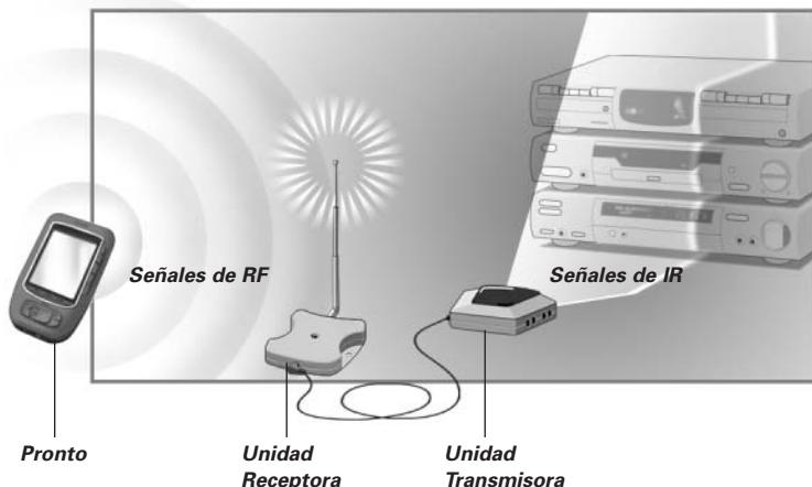
Cuando la señal de la unidad Transmisora no llega a todos los dispositivos o se transmite con excesiva potencia, se pueden utilizar los **emisores de IR duales** incluidos. Los emisores de IR duales pueden configurarse de dos maneras distintas:
