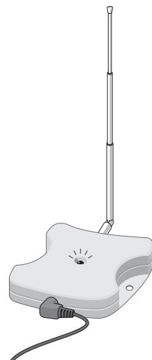
**Remarque** N'utilisez pas la télécommande Pronto lorsque vous positionnez le Récepteur car les interférences RF et le fonctionnement de la télécommande Pronto feront clignoter le voyant correspondant.
