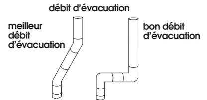
Utiliser un **conduit métallique de diamètre de 10,2 cm (4 po)**. Planifier l'installation pour introduire le nombre minimal de coudes et de changements de direction.
