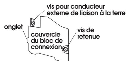
2. Ôter la vis de retenue et le couvercle du bloc de connexion.
