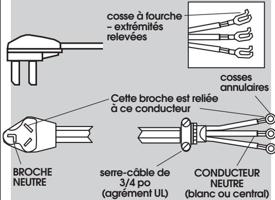
Le cordon d'alimentation à trois conducteurs doit comporter trois conducteurs de cuivre no 10, et on doit disposer d'une prise de courant à trois alvéoles de type NEMA 10-30R.
