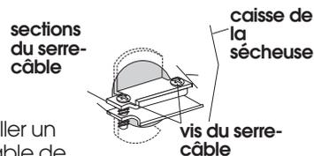
3. Installer un serre-câble de 3/4 po (agrément UL, avec marque sur le serre-câble) dans le trou au-dessous de l'ouverture du bloc de connexion. Serrer les vis du serre-câble juste assez pour que les deux parties du serre-câble soient maintenues ensemble. Faire passer le câble d'alimentation entre les deux plaquettes.
