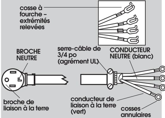
Le cordon d'alimentation à quatre conducteurs doit comporter quatre conducteurs de cuivre no 10, et on doit disposer d'une prise de courant à quatre alvéoles à type NEMA 14-30R. Le quatrième conducteur (liaison à la terre) doit être identifié par un isolant vert et le conducteur neutre par un isolant blanc.
