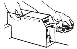
Pour une sécheuse dotée d'un mécanisme d'insertion à coulissement, utiliser l'ensemble d'adaptation fourni avec la sécheuse.
