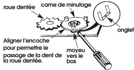
Aligner l'encoche pour permettre le passage de la dent de la roue dentée.
