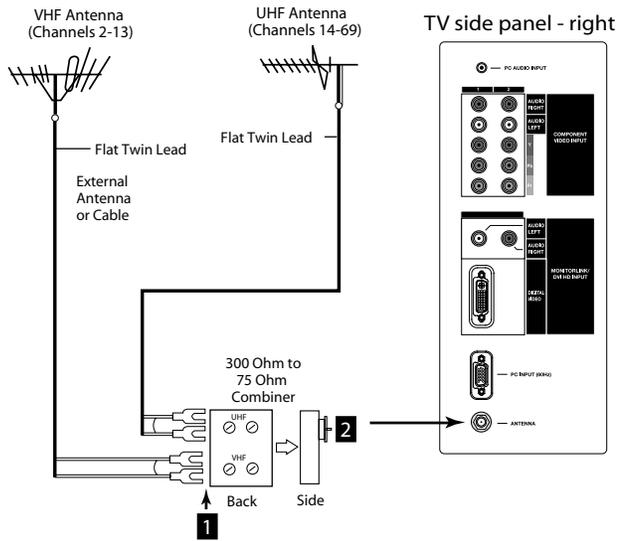
Figure 1. Connecting separate UHF and VHF antennas.
