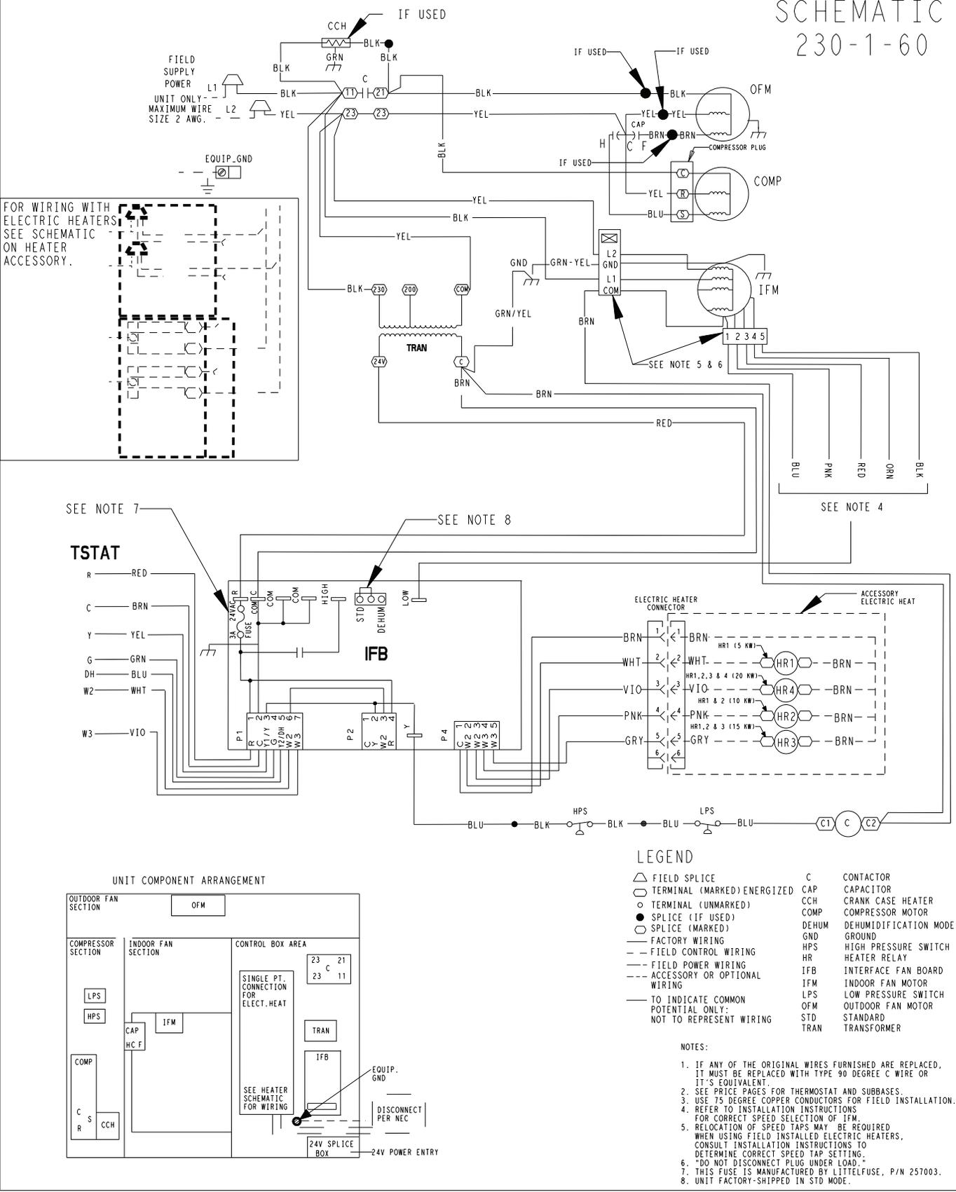
**Fig. 12 - Connection Wiring Diagram 208/230-1-60**
