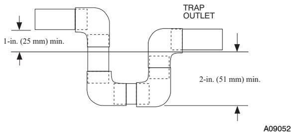
**Fig. 8 - Condensate Trap**
