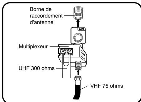
Raccordez le câble VHF de 75 ohms et le câble à conducteurs jumelés UHF de 300 ohms au multiplexeur (en option) et branchez ce dernier sur la borne d'antenne.
