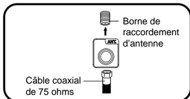
Si vous êtes abonné aux services de base du câble sans convertisseur/débrouilleur, branchez directement le câble coaxial de 75 ohms sur la borne d'antenne se trouvant à l'endos du téléviseur.
