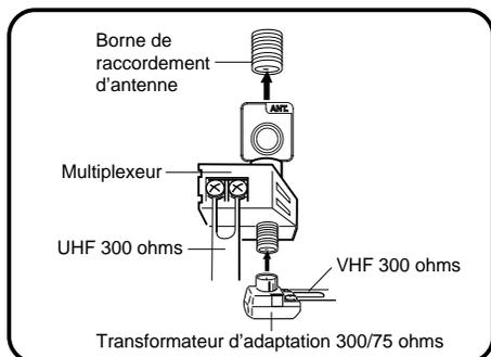
Raccordez le câble à conducteurs jumelés UHF de 300 ohms à un multiplexeur (en option). Raccordez le câble à conducteurs jumelés VHF de 300 ohms au transformateur d'adaptation 300/75 ohms. Raccordez le transformateur au multiplexeur, puis branchez le multiplexeur sur la borne d'antenne.
