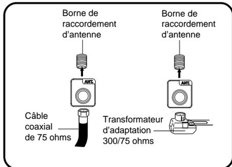
Raccordez le câble de 75 ohms de l'antenne combinée VHF/UHF à la borne de raccordement d'antenne.
