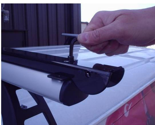
Coloque el montaje de barra sobre la barra de carga.
