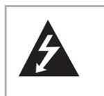
Ce symbole indique qu'une tension dangereuse, constituant un risque de choc électrique, est présente dans cet appareil. Cette étiquette est située au dos de l'appareil.
