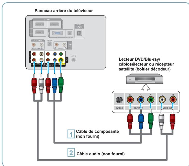
**1** Branchez un câble composant entre les prises COMPONENT IN (1 ou 2) [Y, Pb, Pr] du téléviseur et les prises COMPONENT [Y, Pb, Pr] du lecteur DVD/Blu-ray/câblesélecteur ou récepteur satellite (boîtier décodeur).
