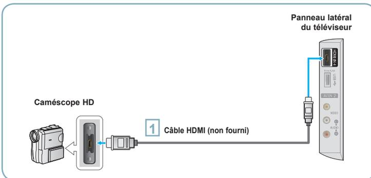
**1** Branchez un câble HDMI entre la prise HDMI 4 du téléviseur et la prise HDMI OUT du caméscope.
