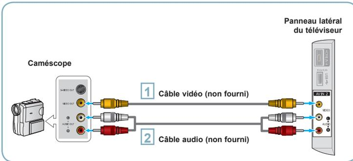
**1** Branchez un câble vidéo entre la prise AV IN 2 [VIDEO] du téléviseur et la prise VDEO OUT du caméscope.
