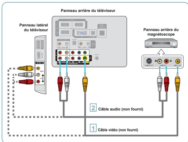
**1** Branchez un câble vidéo entre la prise AV IN 1 [Y/VIDEO] ou AV IN 2 [VIDEO] du téléviseur et la prise VIDEO OUT du magnétoscope.
