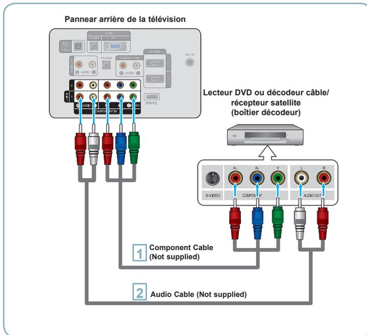
**1** Branchez un câble composant entre les prises COMPONENT IN (1 ou 2) [Y, PB, PR] du téléviseur et les prises COMPONENT [Y, PB, PR] du lecteur DVD ou du décodeur câble/récepteur satellite (boîtier décodeur).
