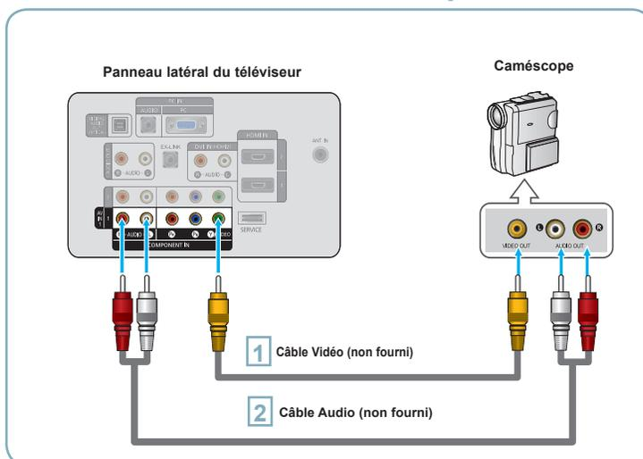
**1** Connectez un Câble Vidéo (ou Câble S-Vidéo) entre les prises AV IN2 [VIDEO] (ou S-VIDEO) du téléviseur et les prises AUDIO OUT du caméscope.
