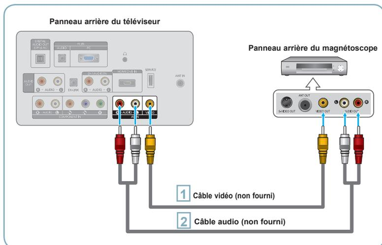
**1** Branchez un câble vidéo entre la prise AV IN [VIDEO] du téléviseur et la prise VIDEO OUT du magnétoscope.
