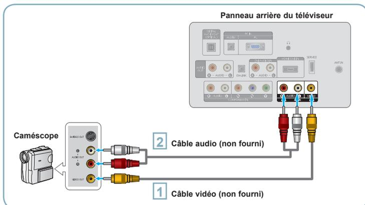
**1** Branchez un câble vidéo entre la prise AV IN [VIDEO] du téléviseur et la prise VIDEO OUT du caméscope.
