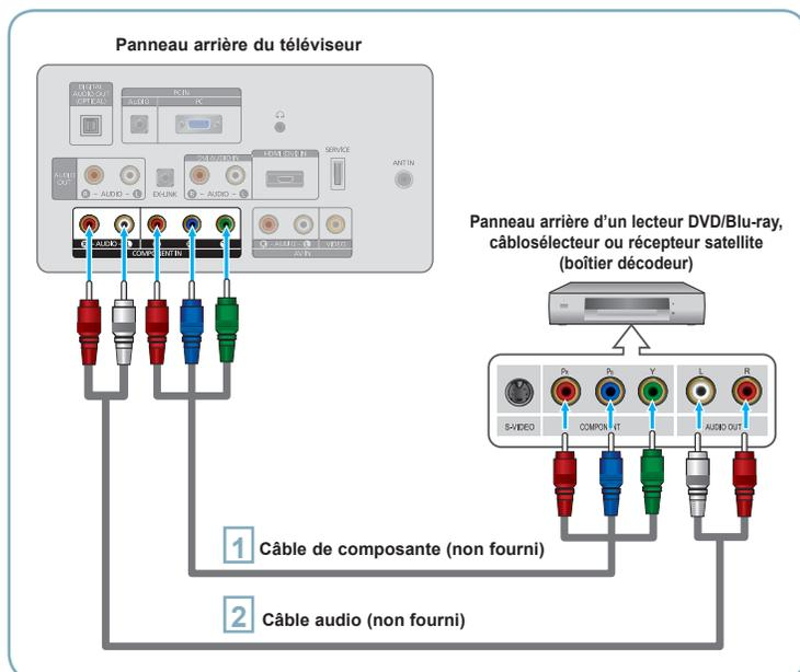
**1** Branchez un câble de composant entre les prises COMPONENT IN [Y, Pb, Pr] du téléviseur et les prises COMPONENT [Y, Pb, Pr] du lecteur DVD / Blu-ray / câblesélecteur ou récepteur satellite (boîtier décodeur).
