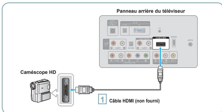
**1** Branchez un câble HDMI entre la prise HDMI (DVI) IN du téléviseur et la prise HDMI OUT du caméscope
