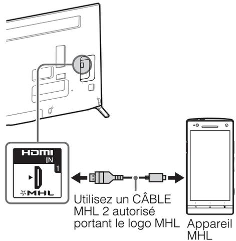
Le téléviseur charge simultanément l'appareil connecté compatible MHL tout en lisant les photos / la musique / les fichiers vidéo. La télécommande du téléviseur peut être utilisée pour contrôler l'appareil connecté compatible avec la fonction MHL.
