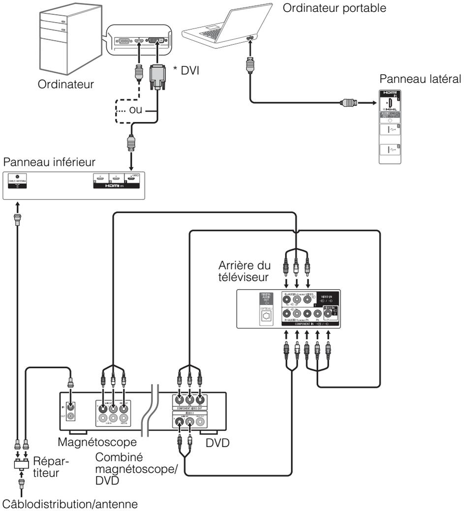
\* La prise DVI ne prend pas en charge les signaux audio. Connecter la sortie audio de l'ordinateur aux enceintes d'ordinateur ou à un récepteur audio-vidéo pour écouter le son de l'ordinateur.
