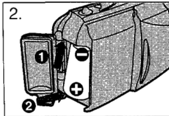
1. Cierre el cubreobjetivo. Presione OPEN **1** para abrir la cubierta del compartimiento de pila **2**.
