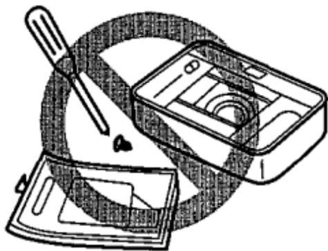
NO INTENTE DESARMAR LA CÁMARA; CONTIENE UN CIRCUITO DE ALTO VOLTAJE. SI LAS PARTES INTERNAS DE LA CÁMARA QUEDAN EXPUESTAS DEBIDO A UNA CAÍDA O DAÑOS, RETIRE DE INMEDIATO LAS PILAS PARA EVITAR UN USO POSTERIOR.
