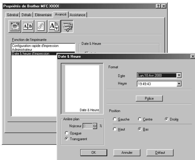
Cliquez sur le bouton **Configuration** pour changer le format de **Date et heure**, **Format**, **Position** et la **Police**. Pour inclure un arrière-plan avec la date et l'heure, sélectionnez **Opaque**. Lorsque l'option **Opaque** est sélectionnée, vous pouvez régler la **Noirceur** de l'arrière-plan date et heure en changeant le pourcentage.
