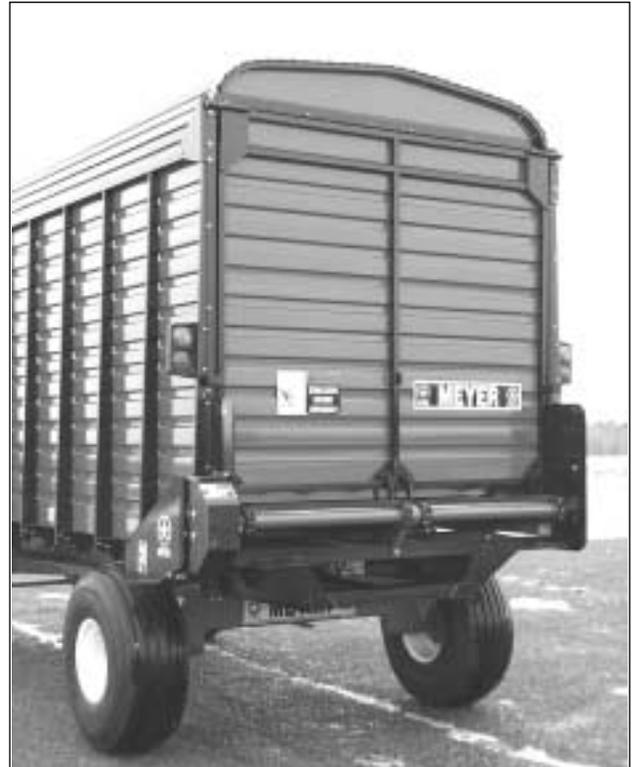
**FIGURE 4. REAR OPENING DISCHARGE DOOR**
