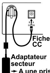
☛ Utilisez uniquement l'adaptateur secteur fourni. L'utilisation d'un autre adaptateur risque d'entraîner des dysfonctionnements.
