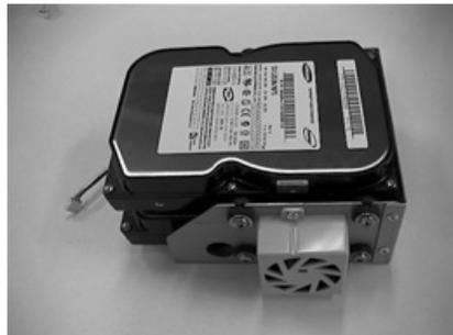
6. 内蔵HDDのHDDブラケットを元の場所に取り付けます。
