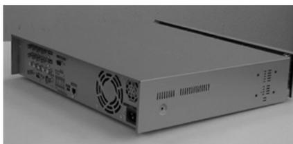
3. 左右にブラケット (HDDブラケット) があります。ここにHDDを取り付けることができます。HDDを取り付けるブラケットを留めているネジを外します。
