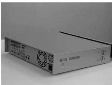
3. 左右にブラケット (HDDブラケット) があります。ここにHDDを取り付けることができます。HDDを取り付けるブラケットを留めているネジを外します。
