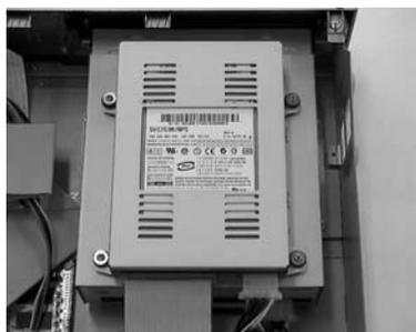
7. HDDブラケットが製品の内側にしっかりと取り付けられていることを確認した後、電源ケーブルと信号通信ケーブル (IDEケーブル) をHDDに接続します。
