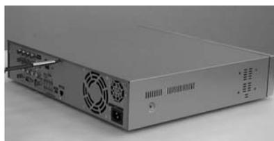
2. 製品からカバーを取り外します。(カバーは、少し後ろ側にスライドさせてから、先に少し後ろ側を持ち上げて外します。)
