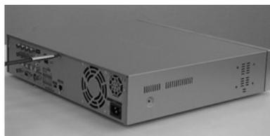
2. 製品からカバーを取り外します。(カバーは、少し後ろ側にスライドさせてから、先に少し後ろ側を持ち上げて外します。)
