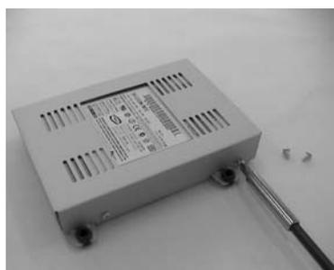
6. 内蔵HDDのHDDブラケットを元の場所に取り付けます。
