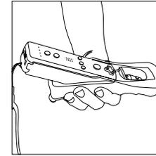
2) Faites passer la tête de la fixation de la poignée sportive par l'ouverture dans la gaine en silicone jusqu'à ce que la tête de la fixation soit à l'extérieur de la gaine en silicone.
