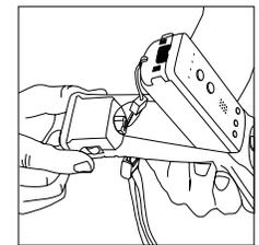
4) En cas d'utilisation de la gaine en silicone pour MotionPlus, vérifiez que MotionPlus est bien connecté fermement à la télécommande Wii. Vérifiez que le matériau de la gaine en silicone n'est pas pincé entre MotionPlus et la télécommande Wii. Puis enclenchez le dispositif de verrouillage de MotionPlus.
