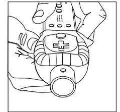
3) Enfilez la gaine en silicone sur le reste de la poignée sportive. N'oubliez pas d'insérer la dragonne de sécurité de la télécommande Wii dans la gaine en silicone. Si la gaine en silicone pour MotionPlus est utilisée, insérez d'abord la dragonne de sécurité dans la fente appropriée de la gaine en silicone pour MotionPlus. Puis enfiler l'accessoire pour MotionPlus dans l'arrière de la télécommande Wii.
