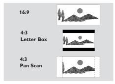
Diese Funktion dient zur Wahl des Bildseitenverhältnisses des angeschlossenen Fernsehgeräts:
