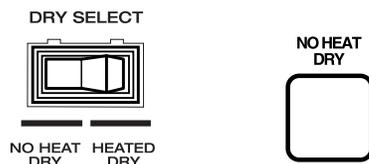
La vaisselle prend plus de temps à sécher et certaines taches peuvent survenir. Pour le meilleur séchage, utiliser un agent de rinçage liquide. Certains articles (tels que les plastiques) peuvent avoir besoin d'être essuyés avec un linge.
