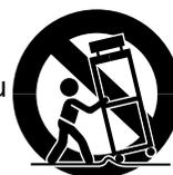
Si le produit et le chariot sur lequel il repose doivent être déplacés ensemble, usez des précautions nécessaires. Un arrêt brusque, un effort excessif ou une surface inégale peuvent le faire basculer.
