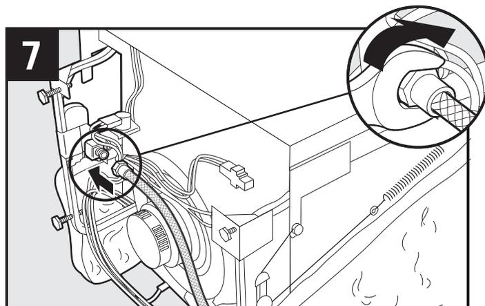
Connect water line if using a flexible braided line. For solid copper line connection refer to step 19./Conecte la tubería de agua usando un conducto tejido flexible. Consulte el paso 19 para la conexión de tuberías de cobre sólido./Raccordez la canalisation d'eau en utilisant un tuyau tressé flexible. Pour le raccordement avec une canalisation en cuivre, reportez-vous à l'étape 19.
